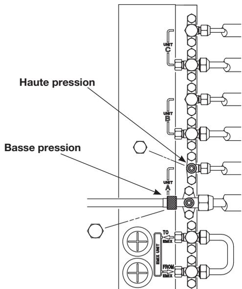
**H** Serrer les connexions à l'aide d'une clé fixe et d'une clé dynamométrique; respecter les couples de serrage.
