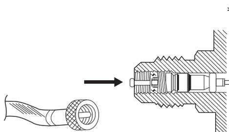
La vanne de service de l'unité extérieure sur laquelle on peut se connecter pour vider le circuit frigorifique, rajouter du réfrigérant et mesurer la pression de fonctionnement, est du type "Schrader". Utilisez un raccord avec poussoir de valve.
