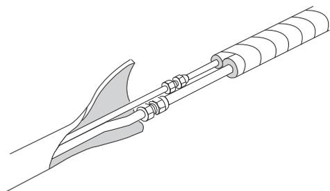
**K** Connecter les unités intérieures, en utilisant, si nécessaire, l'adaptateur sur les vannes de basse pression. Enlever les bouchons des vannes de l'appareil. Ensuite faire démarrer la pompe à vide pendant le temps conseillé dans le tableau (vide de 10 mm Hg absolus).
