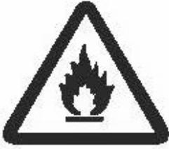
L'appareil est chargé d'un gaz inflammable R290.
