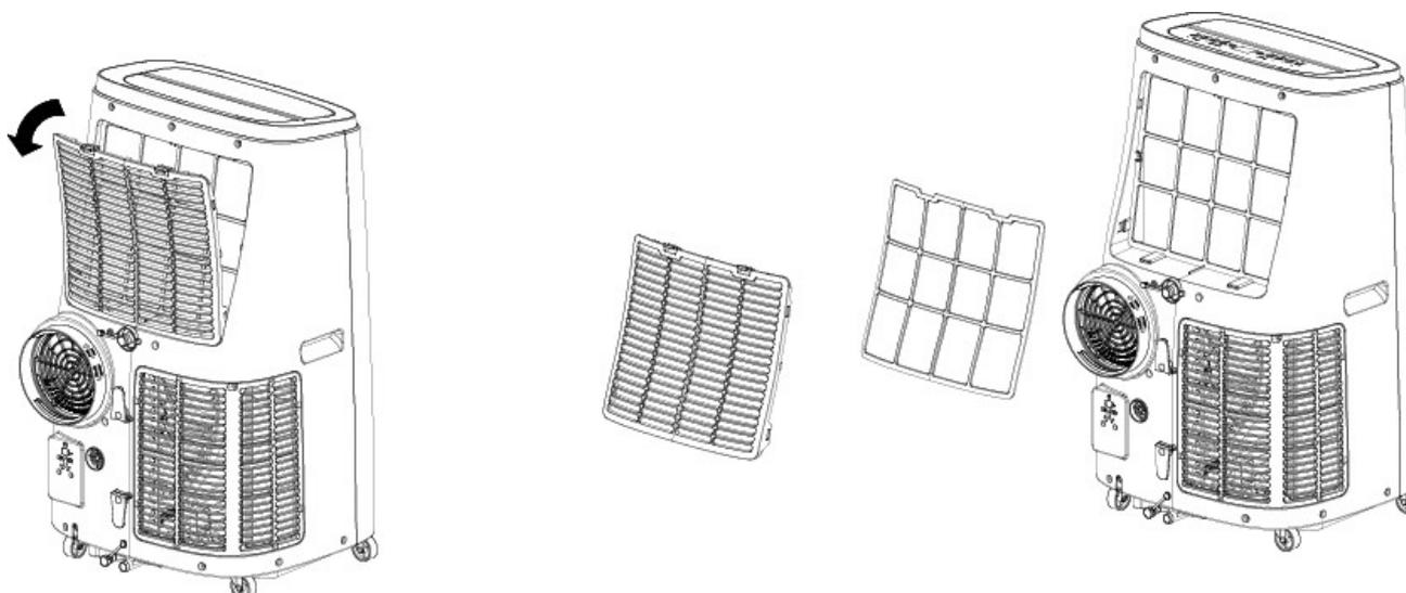
Utiliser un aspirateur pour retirer la poussière du filtre supérieur remous. Si jamais cela ne suffit pas, laver le filtre avec de l'eau tiède et éventuellement un détergent neutre, le rincer à l'eau froide et le laisser sécher à l'air libre avant de le remettre en place. Une fois le filtre repositionné, refermer la grille et remettre le climatiseur en marche.
