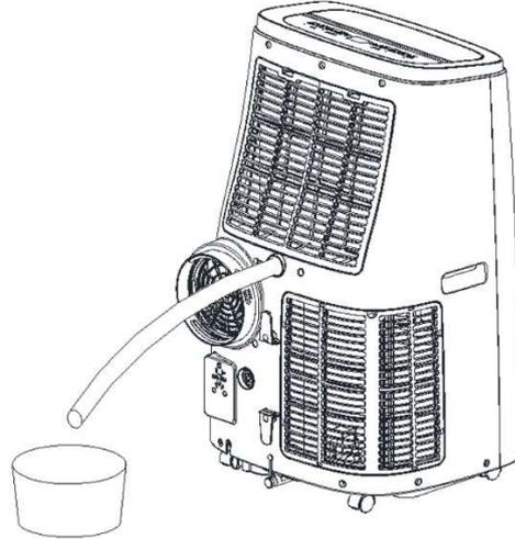
3. Ensuite, insérer le tuyau de drainage dans le tuyau de raccordement.
