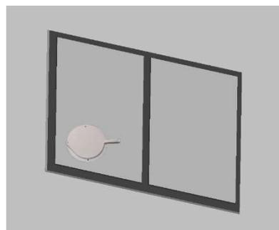
3. Insérer le raccord circulaire pour kit hublot (A) dans le tuyau flexible et insérer le tuyau flexible rétractable avec raccord circulaire dans le hublot sans son bouchon
