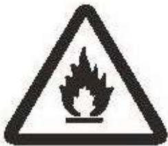
L'appareil est chargé d'un gaz inflammable R290.
