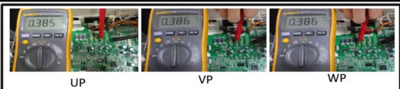
Usare il multimetro per verificare il voltaggio tra U~P, V~P, W~P
