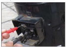
Selezionare il multimetro in ohm e misurare I valori di resistenza tra UV \ UW \ VW
