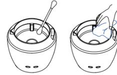
Hinweis: Falls die Nebelmenge nach längerem Betrieb (etwa 3000 Stunden) nachlassen sollte, muss eine neue Keramikscheibe installiert werden. Eine neue Keramikscheibe und das passende Werkzeug erhalten Sie bei Ihrem Händler vor Ort.
