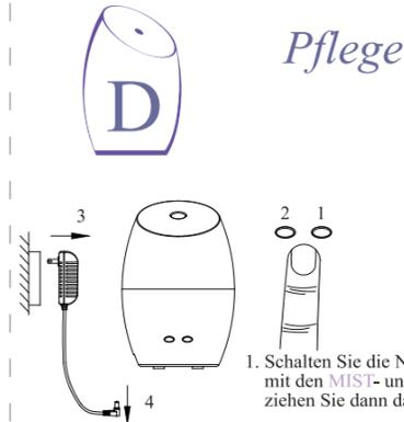
1. Schalten Sie die Nebel- und Leuchtenfunktionen mit den MIST- und LAMP-Tasten aus, ziehen Sie dann das Netzteil aus der Steckdose.
