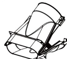
Raccord terminal pour fenêtre fourni divisé en deux parties qui doivent être joint avec 2 onglets qui s'emboîtent (2).
