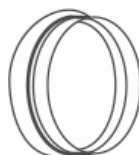
Raccord à appliquer sur l'unité à laquelle brancher le tuyau d'expulsion de l'air
