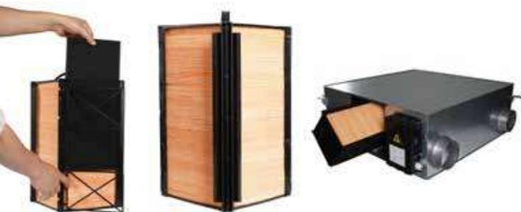
Lo scambiatore di calore, utilizzato per recuperare efficacemente l'energia dell'aria di scarico e scambiarla con l'aria di mandata, è composto da un nucleo in carta e da un telaio in resina che include il filtro e la guida per facilitarne l'installazione. La membrana più sottile dello scambiatore garantisce una migliore conduttività termica e una maggiore efficienza di scambio termico.
